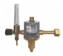
Mit angebautem Durchflussmengenmesser und Anzeige des Flaschendruckes. Integriertes Sicherheitsventil und Absperrspindel am Durchflussmesser. Messgenauigkeit des Flowmeters +/- 10%. Lieferbar in drei verschiedene Durchflussbereichen (s.unten).
