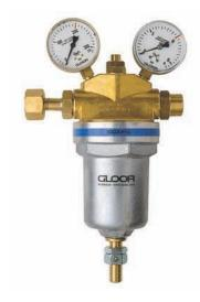
Mit aufgebauten Inhalts- und Arbeitsmanometern und integriertem Sicherheitsventil. Mit Lötnippel am Sicherheitsventil zur Ableitung der Gase ins Freie. Standardausführung für Hinterdruck bis 10 bar. Als Option bis 20, resp. 30 bar (s. unten).
