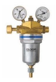
Hochleistungs-Druckreduzierventil (Aufbau gleich wie Art.7900, jedoch für Eingangsdruck bis 300 bar). Mit aufgebauten Inhalts- und Arbeitsdruckmanometern und integriertem Sicherheitsventil. Standardausführung für Hinterdruck bis 10 bar. Als Option bis 20, resp.30 bar (s.unten).
