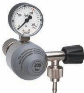
Manodétendeur avec manomètre pour la pression de la bouteille, mais sans manomètre de pression de travail. Pression de travail fixement ajustée; soupape de sécurité intégrée. Un fuseau de réglage fin permet une régulation exacte de petites prises de gaz (également apte à l'aération d'aquariums).
