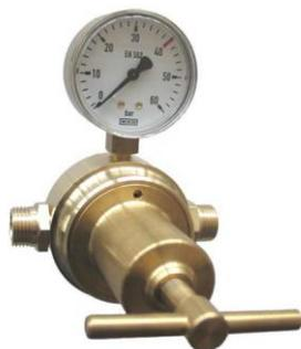
Détendeur basse pression avec manomètre monté de pression de travail ainsi que vis de régulation pour ajustage de la pression de travail jusqu'à 40 bars. Membrane en NBR, filtre en métal fritté dans l'entrée.
