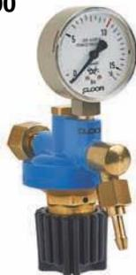
Manodétendeur basse pression avec manomètre monté (diamètre 63 mm) et vis de réglage pour la régulation de la pression de travail.
