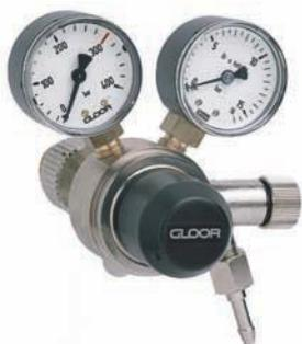
Manodétendeur avec manomètre montés, soupape de sécurité intégrée et robinet de sortie. Entrée vers l'arrière, vis de régulation vers de devant. Matériel: laiton, nickelé. Filtre (métal fritté) en bronze; membrane en néoprène EFFBE.
