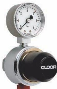
Manodétendeur basse pression pour gaz purs (6.0). Filtre (en métal fritté) à l'entrée. Régulation de pression par membrane en métal. Manomètre de travail réglable en continu, au choix 0-4 ou 0-10 bars.
