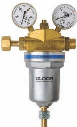
Détendeur à haut rendement (même construction que l'Art. 7900, mais pour pression d'entrée jusqu'à 300 bar). Avec manomètres de contenu et de pression de travail montés et soupape de sécurité intégrée. Version standard avec pression de travail jusqu'à 10 bars. Comme option également livrable jusqu'à 20, resp. 30 bars (v.dessous).
