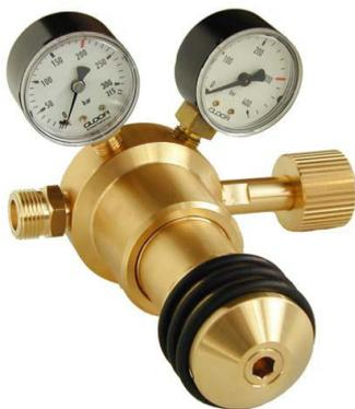
Le détendeur est disponible dans une version pour une pression de travail jusqu'à 100 bars ou jusqu'à 200 bars. La pression secondaire peut être ajustée au dispositif de réglage progressivement entre 10 – 100 bars, resp. entre 10 – 200 bars. Pour un ajustage facile de la pression, le dispositif de réglage a un hexagone en face, de manière que l'ajustement de la pression peut également être fait avec une clé pour vis à six pans creux 8 mm.
