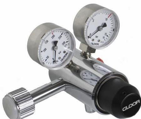
Le manodétendeur est muni d'un manomètre haute pression (pression de la bouteille) ainsi que d'un manomètre basse pression pour afficher la pression de travail réglée sur le deuxième étage, d'un filtre (métal fritté) intégré ainsi que d'une soupape de sécurité. Régulation de pression par membrane en inox.
