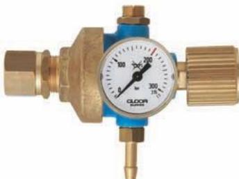
Manodétendeur avec manomètre pour haute pression (diamètre 40 mm) pour l'indication de la pression de la bouteille. Pression de travail jusqu'à 8 bars (réglée fixement au choix du client). Soupape de sécurité intégrée.
