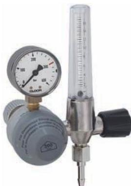
Manodétendeur avec débitmètre monté avec pointeau de réglage fin (qui sert également de robinet d'arrêt) et soupape de sécurité. Exactitude de mesure du débitmètre +/-10%. Livrable en version pour trois domaines de débits différents (v. ci-dessous).
