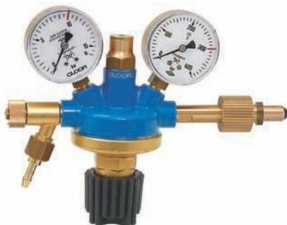
Manodétendeur standard (même construction comme Art. 5100, mais pour pression d'entrée jusqu'à 300 bars) avec excellente constance de pression. Avec manomètres montés, soupape de sécurité intégrée et robinet de sortie.
