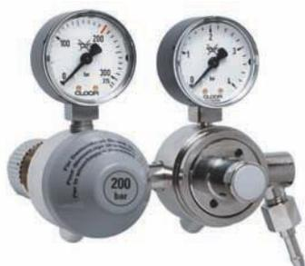
Manodétendeur avec détente en deux étages avec indication de la pression de la bouteille ainsi que de la pression de travail. Particulièrement apte aux applications qui demandent une pression secondaire très constante (pression de travail réglée fixement, sur demande du client entre 0.5 à 3 bars). Egalement livrable pour des appareils d'analyse avec membrane revêtue de téflon.
