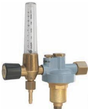
Manodétendeur basse pression avec débitmètre monté. Le débitmètre avec corps flottant permet une lecture facile du débit. Exactitude de mesure du débitmètre +/-10%. Livrable pour trois domaines de débits : 0–3, 0–16 ou 0–32 l/min. Egalement livrable avec vanne de ventilation à la sortie.
