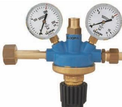
Ce manodétendeur a la même construction que l'Art. Nr. 5100 et est apte comme détendeur central pour des petites alimentations centrales en gaz. Comme option avec pression de travail jusqu'à 60 bar. Raccord à souder à la soupape de sécurité pour la déviation des gaz à l'extérieur.
