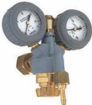
Mini manodétendeur avec débitmètre, soit avec indication l/min du débit sur le manomètre secondaire. Soupape de sécurité intégrée. Le débit est ajusté (avec la vis de réglage) par une variation de la pression de travail et par une vis d'étranglement dans la sortie.
