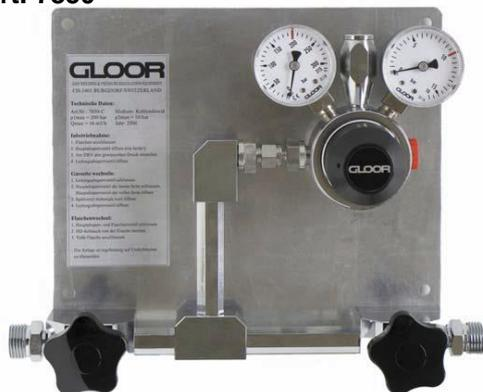
Dispositif de commutation manuelle pour gaz purs jusqu'à une pureté 6.0, se composant de deux robinets d'arrêt haute pression pour une exploitation alternative des bouteilles, manodétendeur principal avec soupape de sécurité ainsi qu'avec sortie de purge. Tous les éléments sont montés sur un tableau en aluminium avec indication spécifique du gaz.
