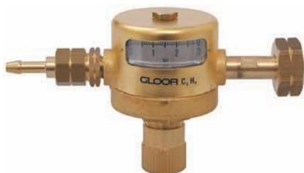
Manodétendeur avec manomètre de travail incorporé, construction compacte et robuste. Indiqué dans les travaux où propane et oxygène sont utilisés en combinaison. Le matériel de la membrane et du siège est NBR.
