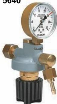
Manodétendeur basse pression avec débitmètre, soit avec indication du débit en l/min sur le manomètre. Le débit est réglé par la variation de la pression de détente.
