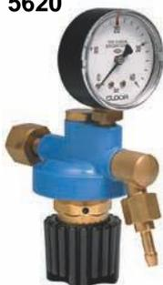
Manodétendeur basse pression pour pression de travail jusqu'à 20 bars, avec manomètre monté et vis de réglage pour la régulation de la pression de travail.
