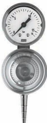
Manodétendeur avec manomètre de contenu de la bouteille. Débit avec vis de régulation entièrement ouverte alternativement 0.25, 0.5, 1.5 ou 2.5 l/min. La vis de régulation sert en même temps de robinet d'arrêt.
