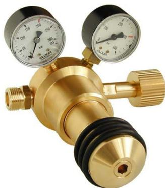
Manodétendeur pour haute pression de travail jusqu'à 100, resp. 200 bars (Construction comme Art. 7900, mais pour pression d'entrée jusqu'à 300 bars). Détendeur à piston qui garantit pour un réglage précis et constant de la pression secondaire.
