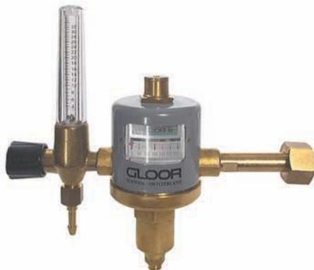
Avec débitmètre monté et manomètre avec indication de la pression de la bouteille. Soupape de sécurité intégrée et robinet de sortie au débitmètre. Exactitude de mesure du débitmètre +/-10%. Livrable en trois domaines de débits différents (v.ci-dessous).
