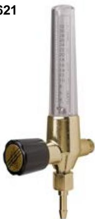
Débitmètre seul, exactitude de mesure +/-10%, avec robinet d'arrêt. Calibré sur une pression d'entrée fixe de 4,5 bars; livrable en trois domaines de débits: 0–3, 0–16 et 0–32 l/min.
