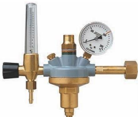
Manodétendeur avec débitmètre monté et manomètre pour l'indication de la pression de la bouteille. Soupape de sécurité intégrée et avec robinet de sortie au débitmètre. Le débitmètre monté avec corps flottant permet une lecture facile du débit. Exactitude de mesure du débitmètre +/-10%.
