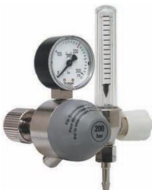
Manodétendeur avec manomètre pour la pression de la bouteille et avec débitmètre monté; soupape de sécurité intégrée. Le débitmètre monté avec corps flottant permet une lecture facile du débit. Membrane en néoprène EFFBE; sur demande également avec membrane revêtue de téflon.
