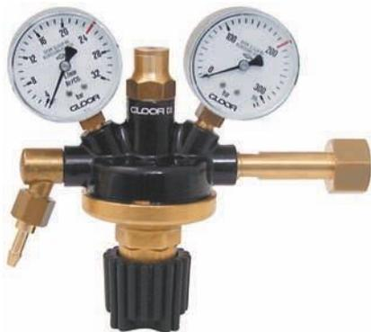
Manodétendeur avec débitmètre, avec indication l/min sur le manomètre secondaire. Soupape de sécurité intégrée. Ce manodétendeur est une alternative avantageuse à la version avec débitmètre monté Art.5150. Avec ce système le débit est réglé par la variation de la pression de travail (et par une vis d'étranglement dans la sortie).
