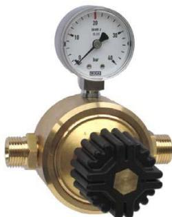
Détendeur basse pression avec manomètre monté de pression de travail ainsi que vis de régulation pour ajustage de la pression du travail. Membrane en NBR, filtre en métal fritté dans l'entrée.
