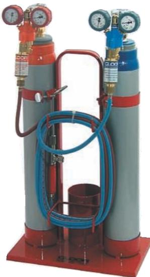
PROFIFLAM – le poste de soudage léger et très maniable, se composant de châssis pour la prise d'une bouteille d'oxygène et d'acétylène avec diamètre 100mm, deux mini-manodétendeurs, deux dispositifs antiretour de flamme, tuyaux, poignée, lance de soudage No. 2, lunettes, allumeur de gaz.
